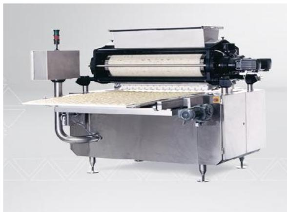
Machine de façonnage (5)
