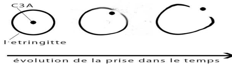
Figure 7 : Schéma expliquant l'intervention de l'ettringite dans la prise
