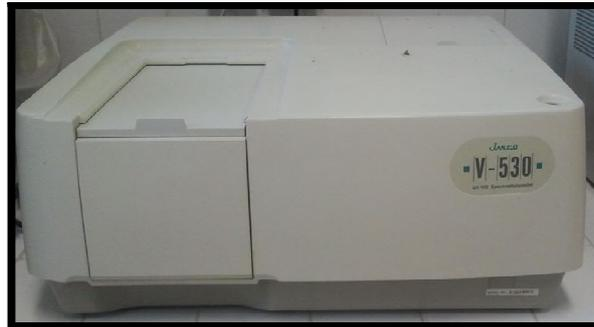
Figure 9 : spectrophotomètre UV
