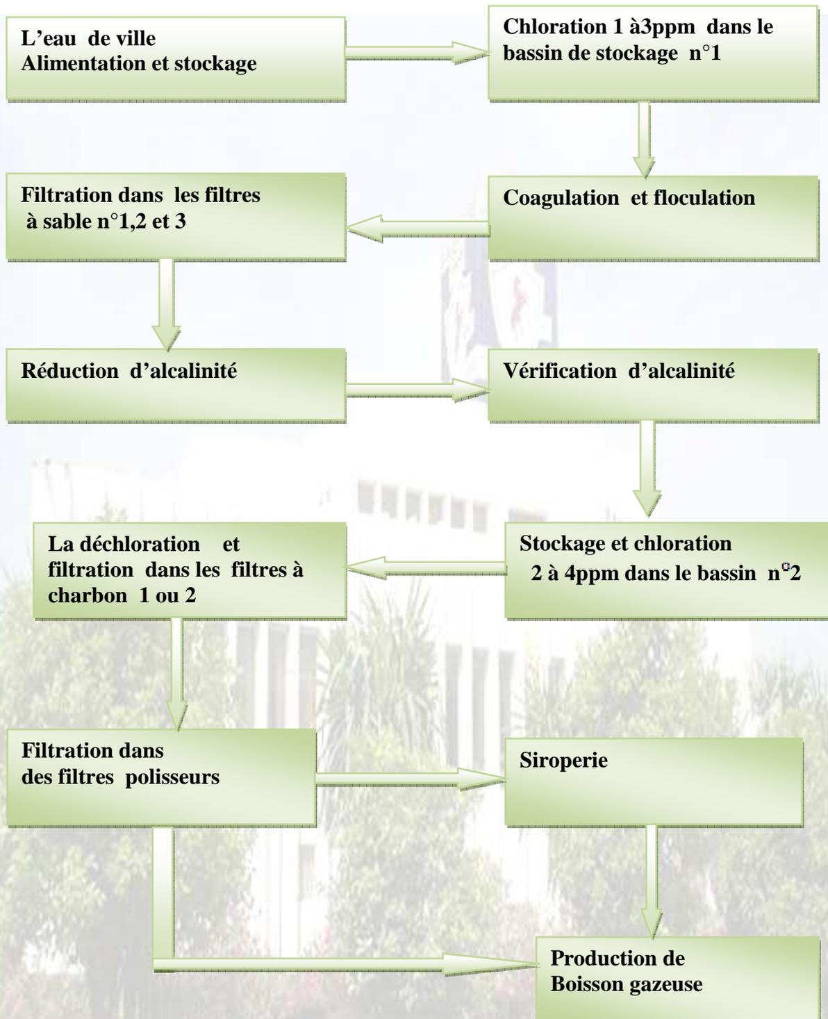
**Figure 2.1-principe de traitement des eaux**
