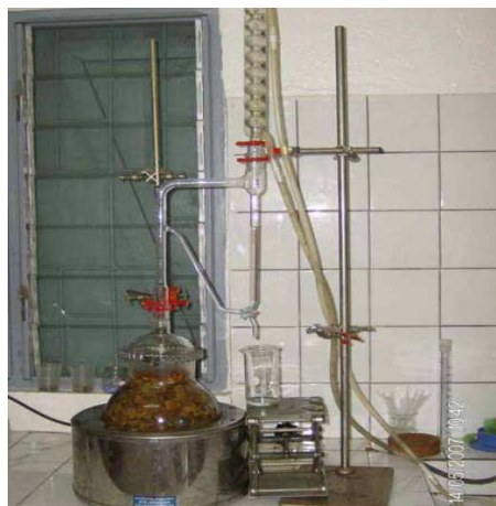
Figure 6 : Système de distillation en laboratoire
