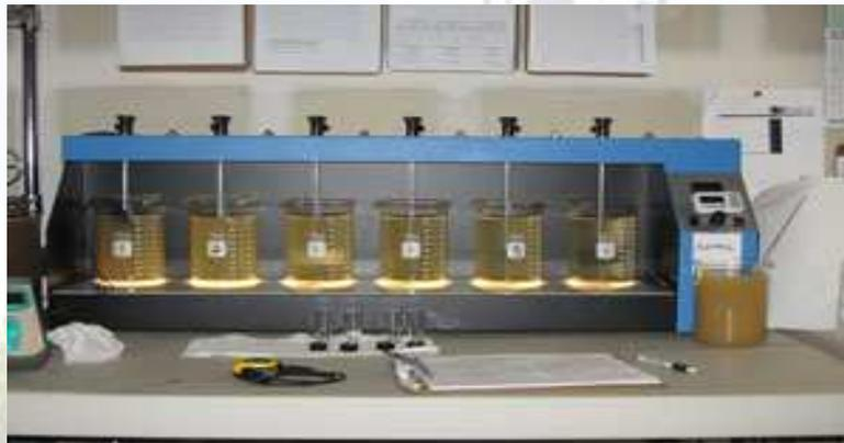
**Image 1 :appareil de jar test**
