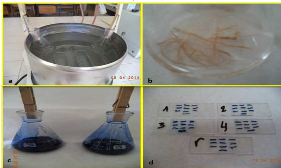
Figure 11 : a : Eclaircissement des racines dans une solution de KOH (10%) à 90°C. b : Blanchissement des racines. c : Coloration des racines éclaircies dans une solution de Bleu de trypan. d : Montage des morceaux de racine entre lame et lamelle.
