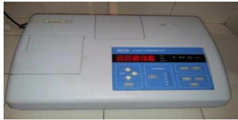
**Figure 7 : Turbidimètre**
