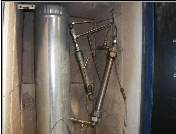
Figure 18. Intérieur du four (colonne, thermocouples et coils)
