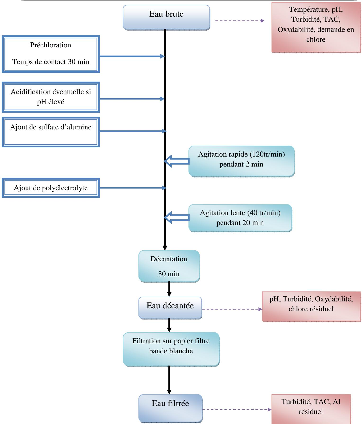
Figure 13 : schéma du procédé de l'essai de floculation
