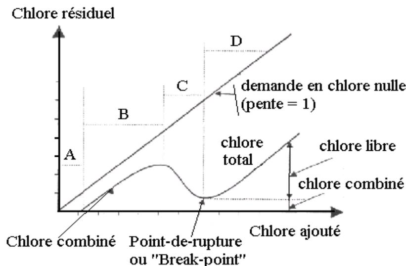
Figure 10 : courbe de la demande en chlore (break-point)
