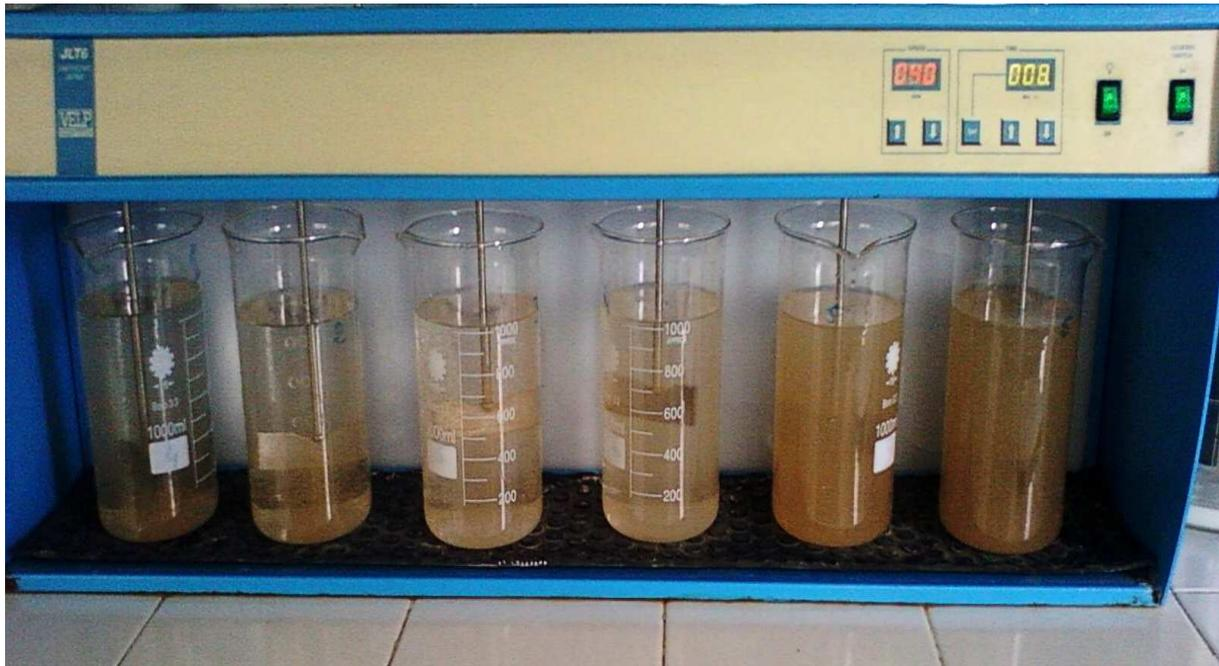
**Figure 12 : Dispositif expérimental de l'essai de floculation (Jar-test)**
