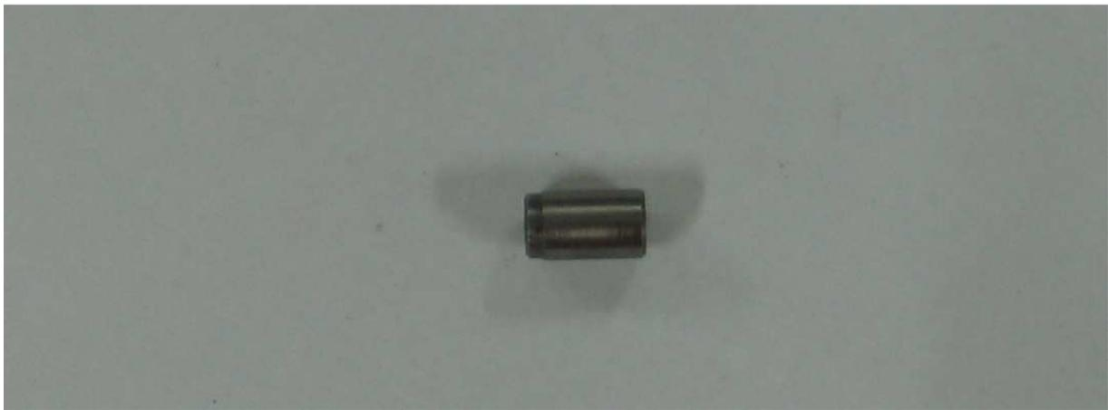
Piston pilote : Pour rôle gérer la distribution des voies vers le piston doseur.
