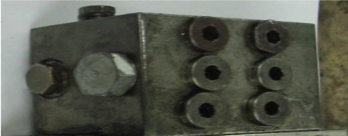
Le bloc d'air : un bloc auxiliaire qui a pour rôle de mener et de mélanger la dose d'huile avec de l'air en obtenant une pulvérisation qui va assurer la lubrification et le refroidissement.
