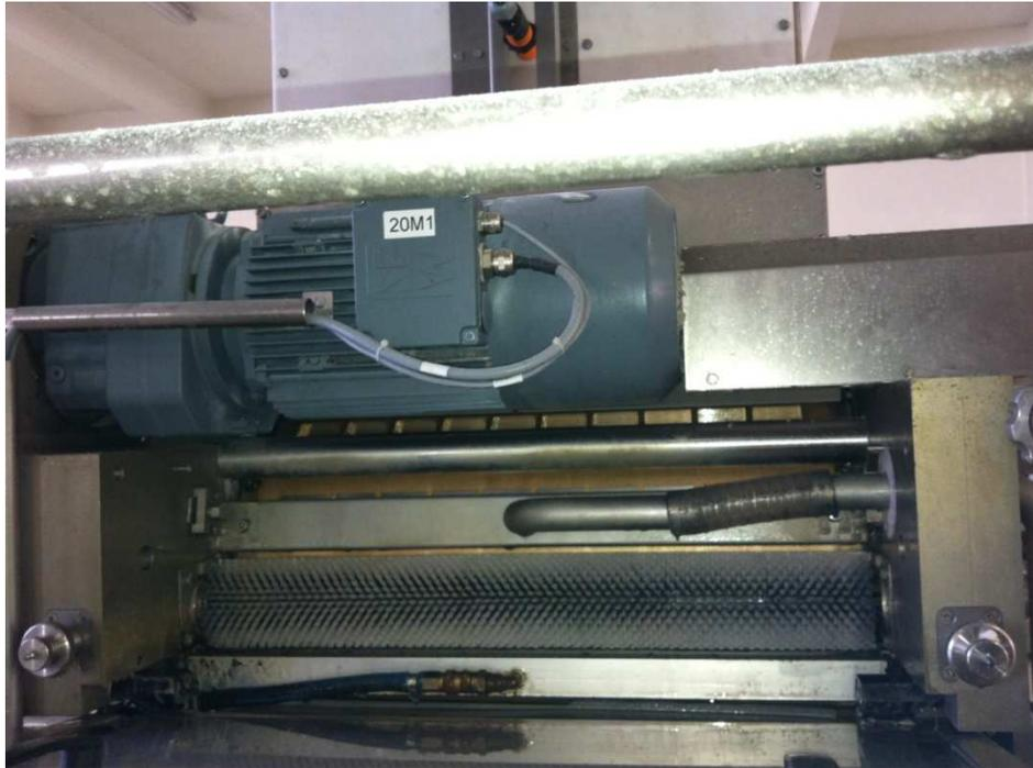
Figure 19 : Vue du tambour de moulage – Partie mouleuse
