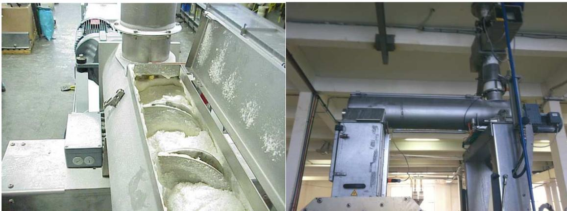
Figure 18 : Hélice d'humidification
