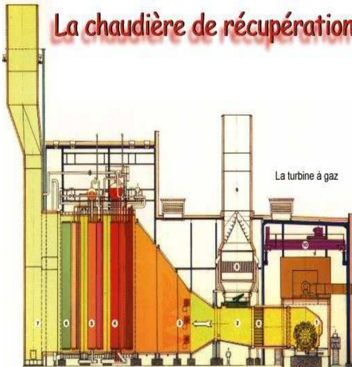
La chaudière de récupération utilise la chaleur des gaz d'échappement de la turbine à gaz. Cette chaleur va servir à réchauffer l'eau d'un réseau de chauffage urbain. Elle permet également de produire de la vapeur d'eau, qui sert à produire de l'électricité. Elle est énorme, on se sent tous petit à côté et il fait chaud.
