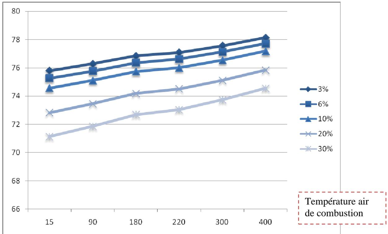
**L'augmentation de la température de l'air de combustion augmente le rendement.**
