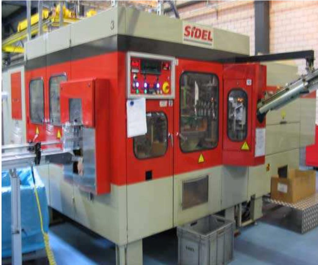
Figure 4 : la machine qui réalise le soufflage
