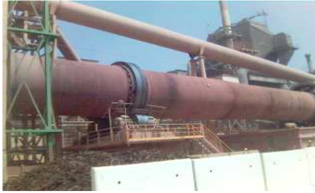
Figure 8 : Four 1 en voie sèche avec une flamme De 2000 °C
