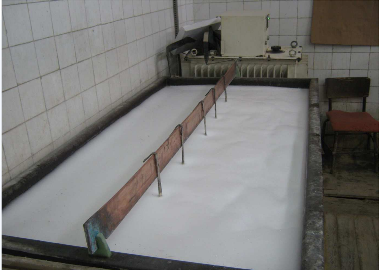
Fig.6 : bain de dégraissage
