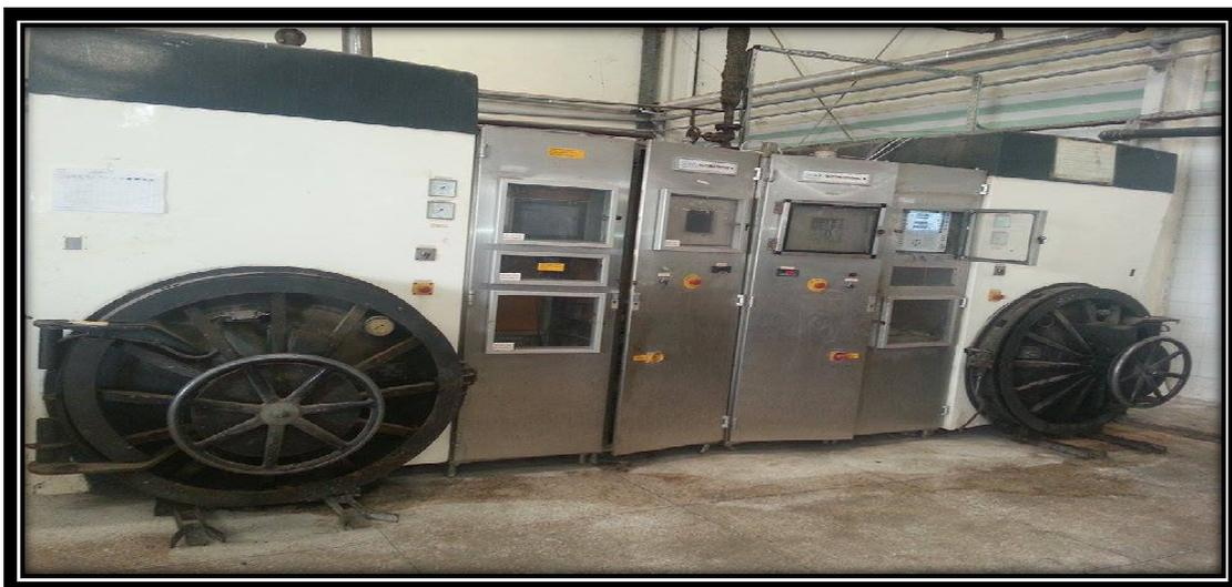
Figure 8 : Autoclave à double entré
