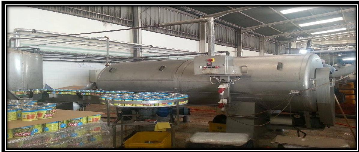
Figure 5 : machine de blanchiment et sertissage
