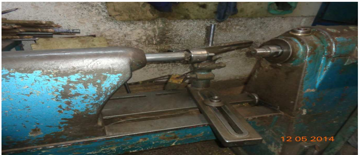
Image 4 : machine de repoussage
