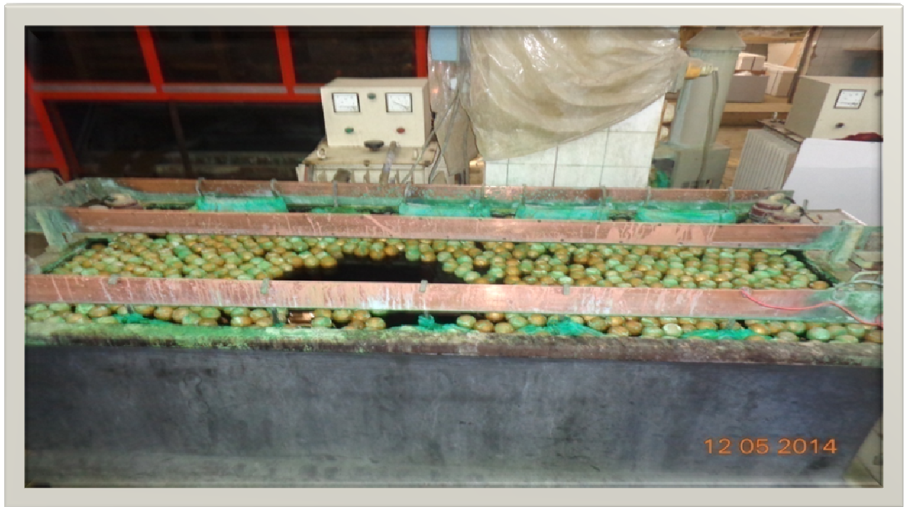
Image16 : le bain de nickelage
