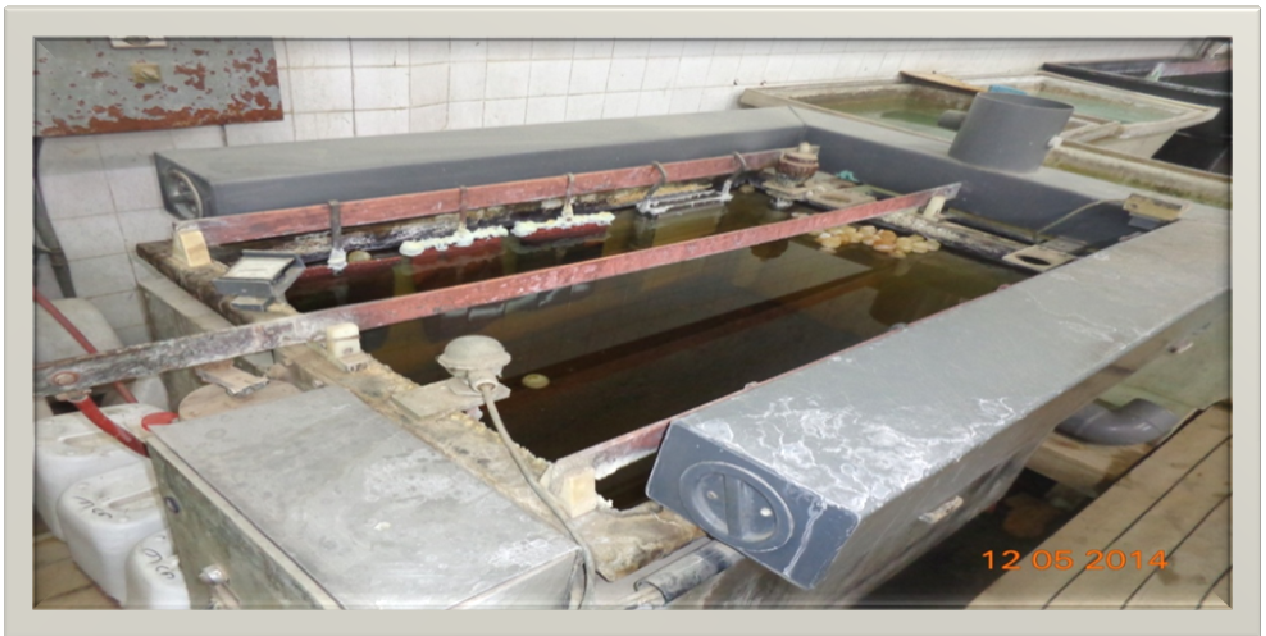
image 14: le bain de cuivrage alcalin
