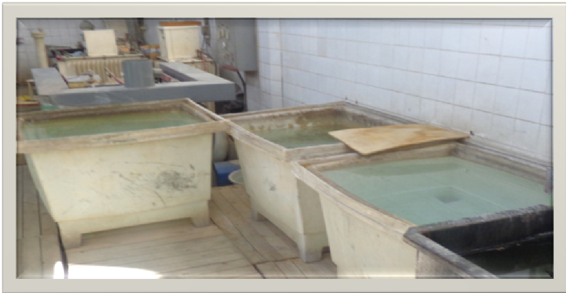
Image 13 : les baigns de rinçage
