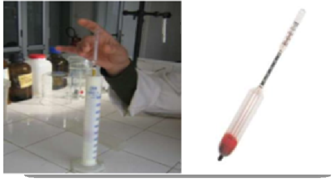
Figure 10 : Mesure de la densité du lait par lactodensimètre
