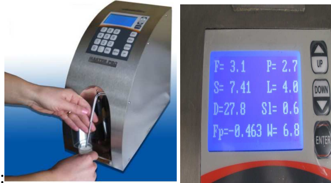
Figure 9 : Milk analyzer de la marque Master Pro
