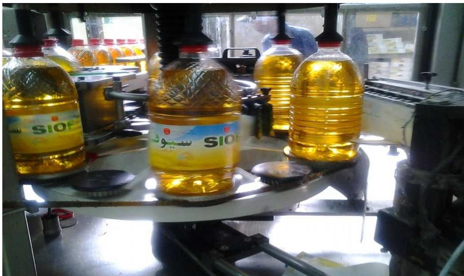
Après vient l'étape d'étiquetage les bouteilles en utilisant une colle spécifique chauffée à plus de 120°C.
