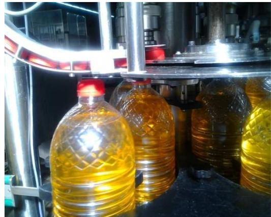
Cette étape consiste à remplir les bouteilles par l'huile à l'aide de la remplisseuse, qui seront par la suite fermées dans la boucheuse. Les bouteilles ainsi remplies et fermées sont amenées vers l'élément de transport (le convoyeur).
