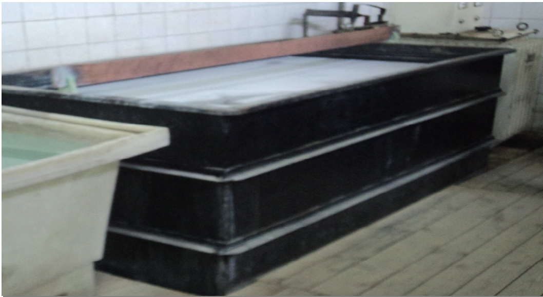
Figure5 : photographie d'un bain de dégraissage
