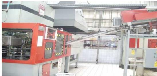
*Photo 2 : Transformation des préformes en bouteilles PET par la Souffleuse*
