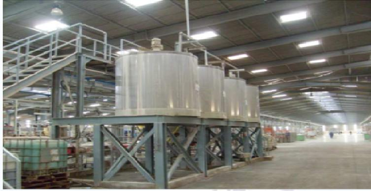
Figure 10 : Cuves de stockage des émaux
