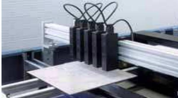
**Figure 16** : La machine Calibreuse (photocellules)
