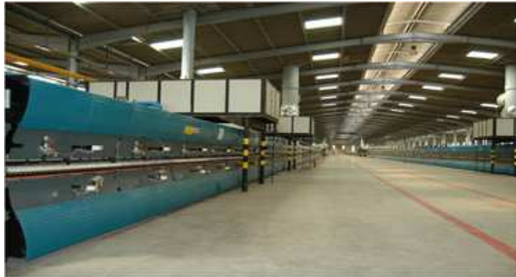
Figure 17 : Four à rouleaux.
