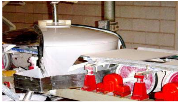
Figure 14 : cloche de l'engobe et de l'email.
