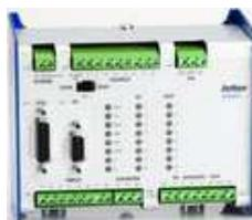
**Figure 27: l'automate JETTER NANO –B**
