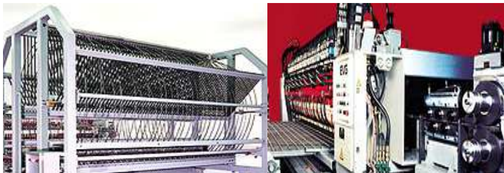
Figure 5 : ligne de soudage des nappes d'armature
