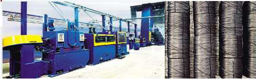
Figure 6 : ligne de laminage à froid RMV
