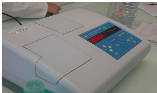
Figure 5 : Turbidimètre
