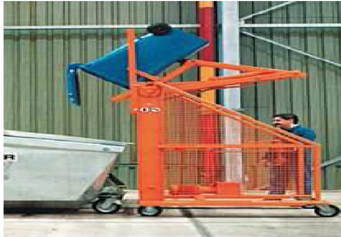
Figure 15 : bascule à déchets
