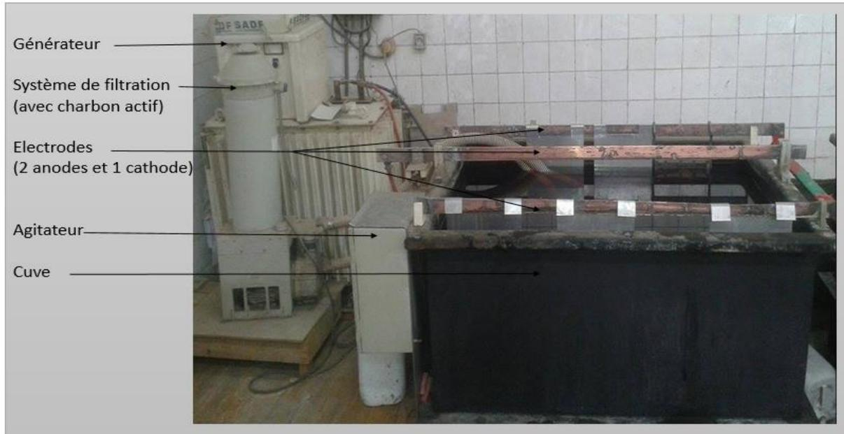
**Figure 11:** Schéma général du bain électrolytique
