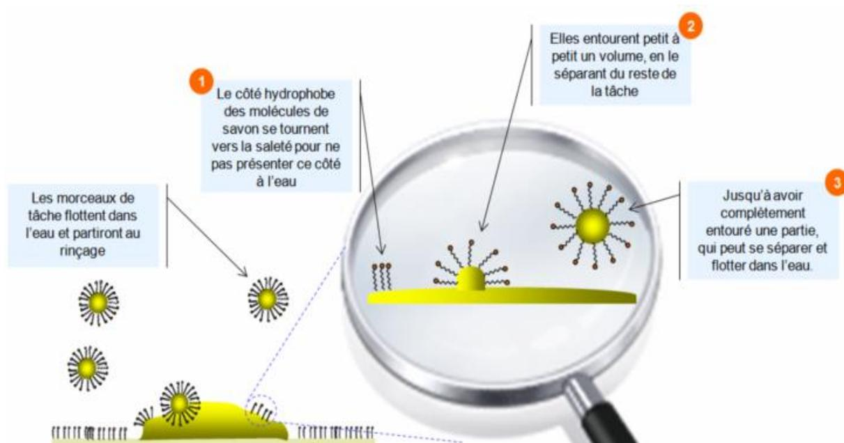
**Figure 8 :** Schéma simplifié des mécanismes d'action d'un savon pendant dégraissage chimique
