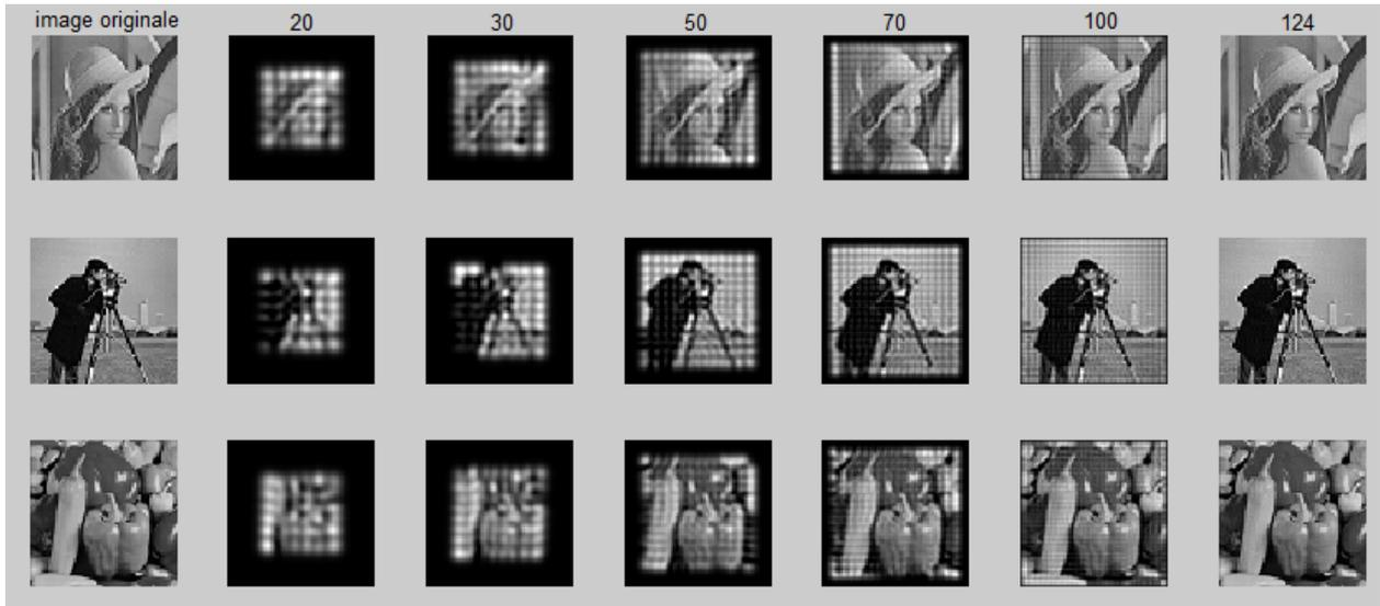
FIGURE 2.27 – reconstruction des images niveau de gris pour ordre  $n+m=20$ ,  $n+m=30$ ,  $n+m=50$ ,  $n+m=70$ ,  $n+m=100$  et  $n+m=124$ .
