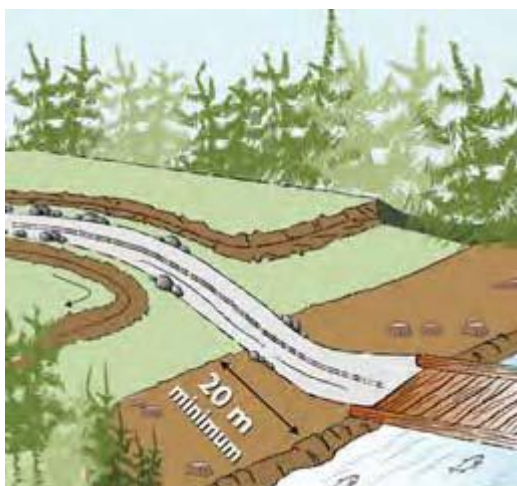
Figure 27 : Détournement des eaux (Guide-saines-pratiques-Section-2)
