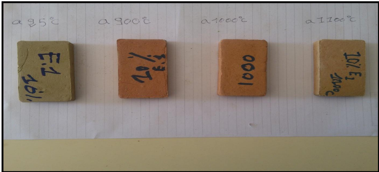
Photo III 1: Variation de la couleur des briquettes de l'échantillon I après cuisson
