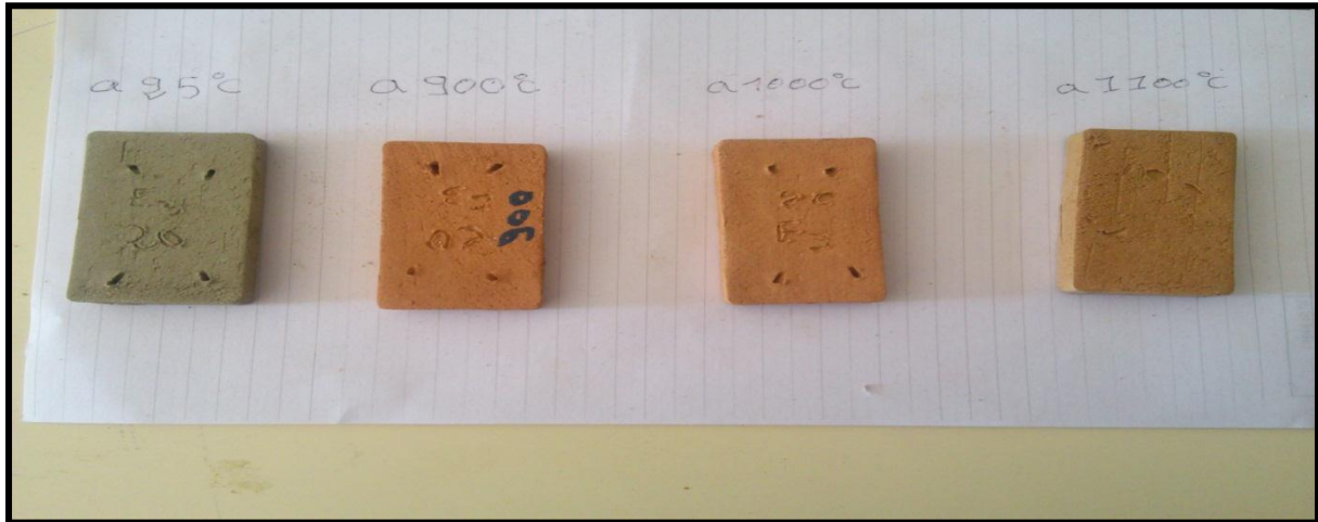
Photo III 3: Variation de la couleur des briquettes de l'échantillon III après cuisson.
