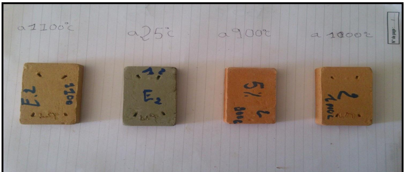
Photo III 2: Variation de la couleur des briquettes de l'échantillon II après cuisson.
