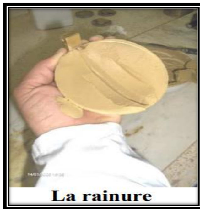
Photo II 2:Photo montrant la forme de la rainure réalisée sur les marnes
