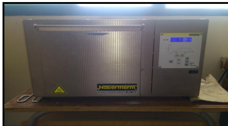
Photo II 4 : Four programmable du laboratoire Géoressources et Environnement FSTF.
