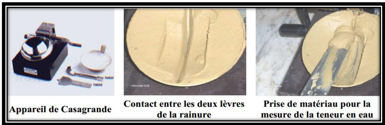
Photo II 3 :L'appareillage utilisé pour déterminer les limites de liquidité et de plasticité.
