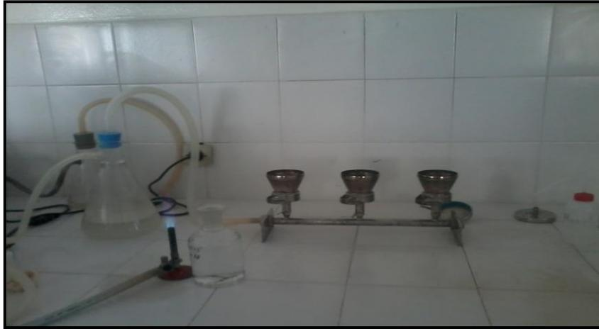
Figure 10 : La méthode de la membrane filtrante
