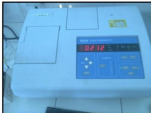
Figure 20 : Turbidimètre
