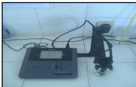
Figure 22 : Conductimètre
