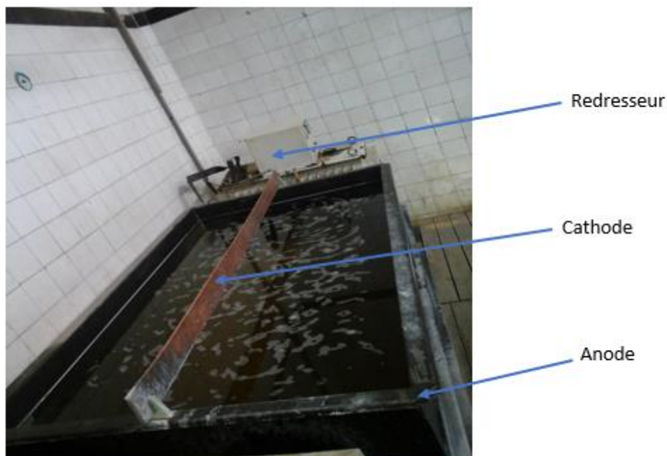
Image 3 : Bain de dégraissage
