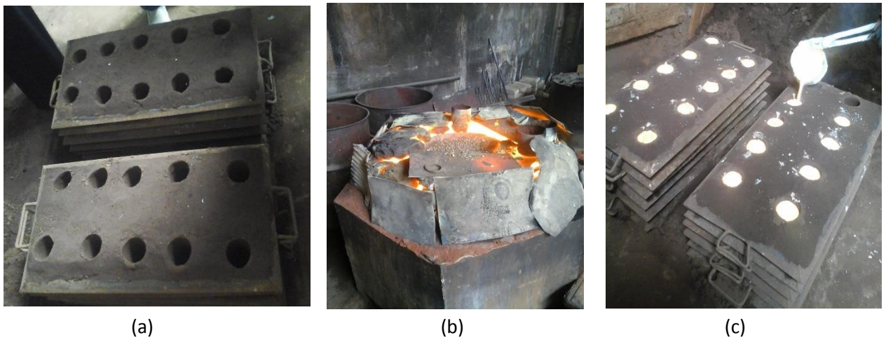
Image 1 : processus de fondre les chutes de laiton
