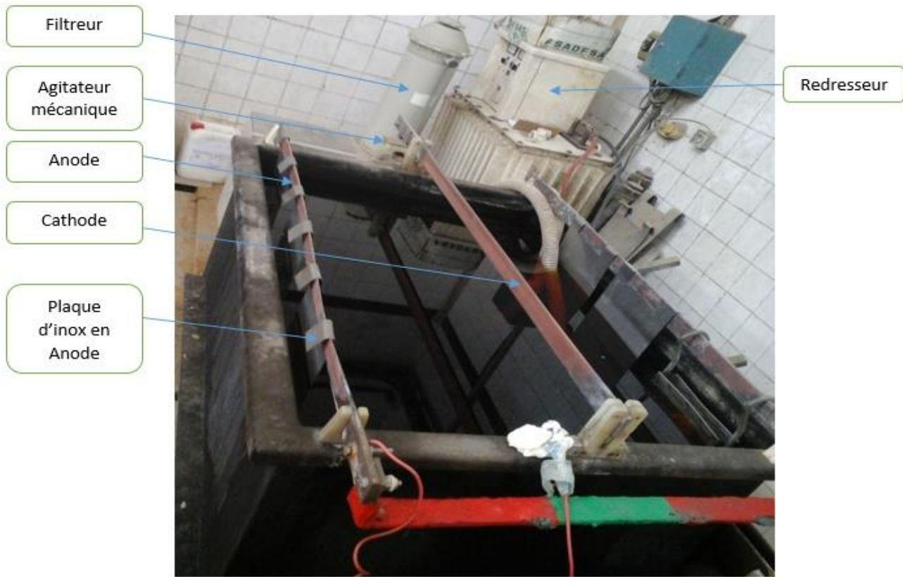
Image 2 : équipements du bain de traitement
