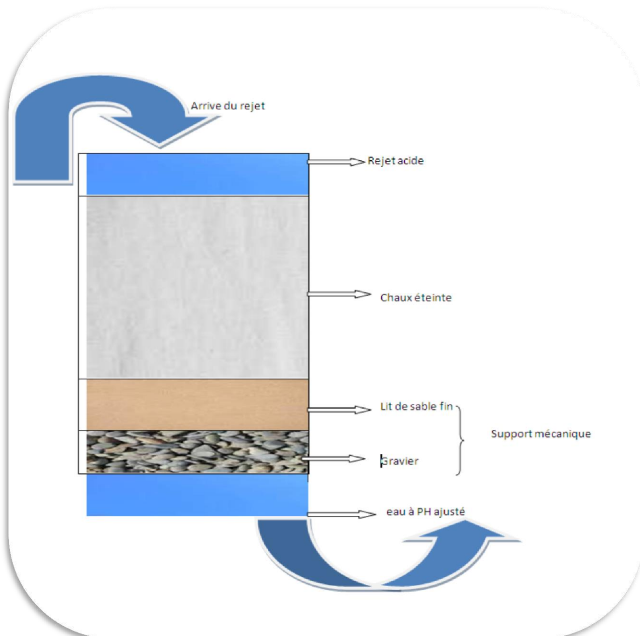
Figure 8 : Schéma d'une fosse de neutralisation
