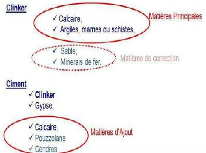
Figure I.5: Matières utilisées dans la production du ciment
