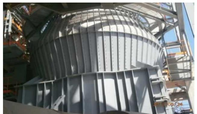
*Figure I.9: Broyeur cru*
