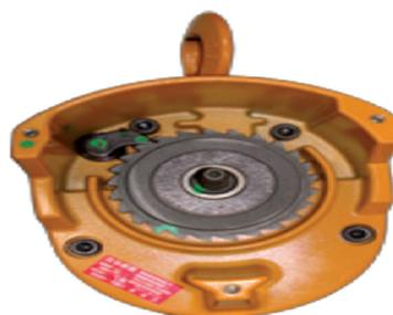
figure II.8 : Système de freinage du palan
