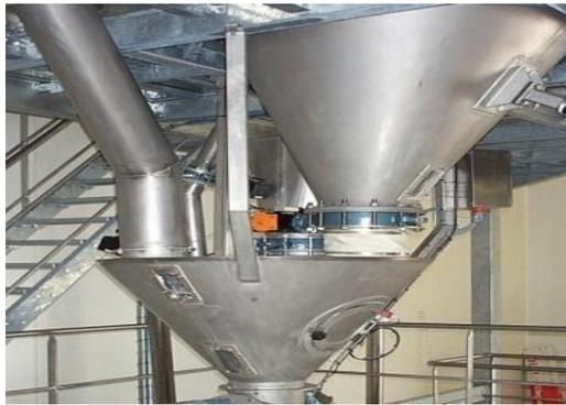
En fonction du produit à fabriquer, la quantité de chaque matière première qui compose le produit fini se diffère. Après le pesage, la matière première est transportée par le transporteur de dosage TD1 et l'élevateur ED1 vers le pré mélange statique puis stockée dans la trémie de réserve qui se situe au dessus du tamiseur rotatif.
