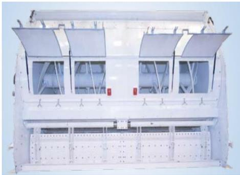
Au cours de cette étape le pré-mélange broyé part vers une mélangeuse qui reçoit des apports de liquides, tels que l'huile, la choline, et les apports d'additifs tels que le pré mix et macro-minéraux (carbonate de calcium, phosphate bi calcique) dosés à l'aide d'une benne peseuse N°3 afin d'obtenir un mélange homogène.
