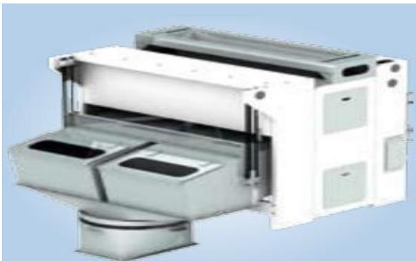
Elle s'effectue à l'aide du tamiseur à l'intérieur duquel s'installent 3 grilles de dimension décroissante. Au cours du tamissage les grands granulés retournent à l'émietteur pour être cassés de nouveau alors que les fins passent vers la presse en suivant les étapes de granulation.
