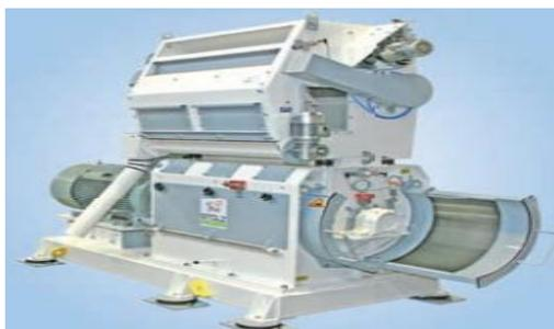
La matière ainsi dosée et pré-mélangée subit un broyage mécanique qui permet de réduire les matières premières à une granulométrie plus petite afin de réaliser des mélanges homogènes et ceci à l'aide du broyeur à marteaux.
