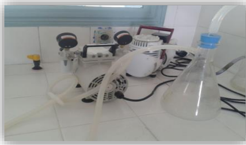
Figure 19 : Pompe à vide
