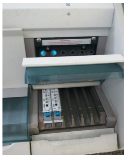
Figure 16 : Mise en place des cartouches et cônes dans l'automate
