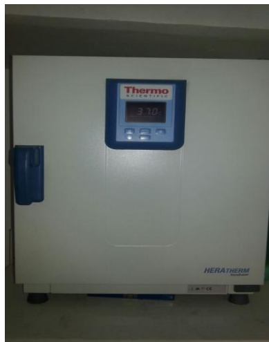
Figure 29 : La cuve où on met les boîtes à pétri, elle doit toujours être réglée à 37°C.
