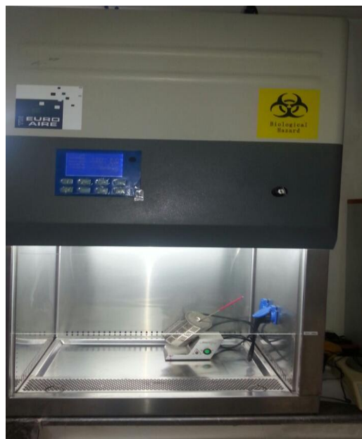
Figure 27 : Le poste de sécurité microbienne, dans lequel on ensemence pour se protéger contre les germes dangereux avec un environnement stérile par UV
