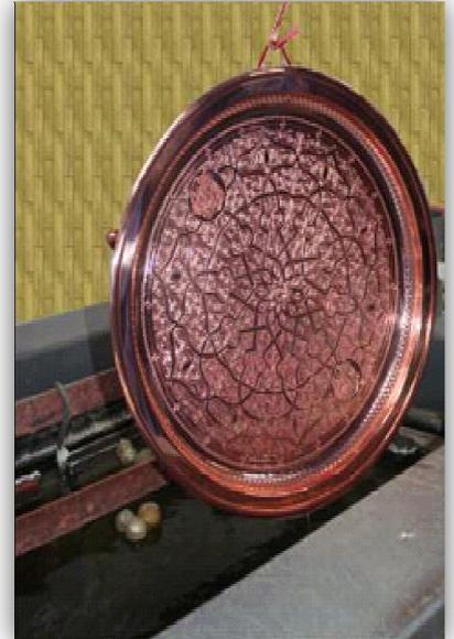
*Photo 16 : le bain de cuivrage alcalin Article cuivré*
