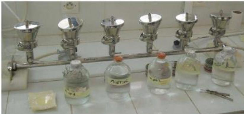
Figure 5 : filtration sur membrane
