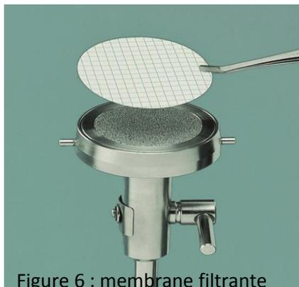
Figure 6 : membrane filtrante
