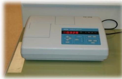
Figure 5 : turbidimètre
