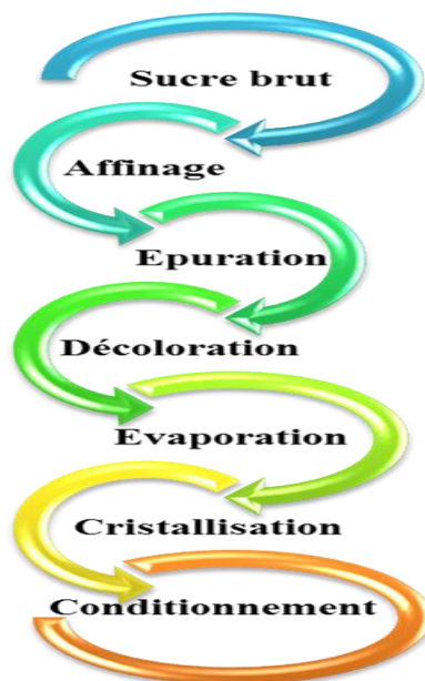
Figure 7 : procédé de fabrication de sucre
