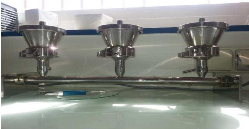
Figure 1 : rampe de filtration trois poste
