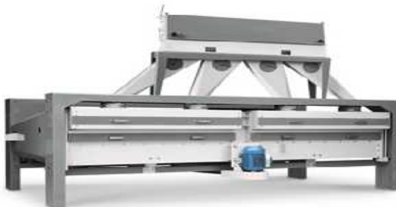
Fig.11: Décorticieuse machine composée de tamis vibrant+ventilateur type de machine Marini modèle 2002
