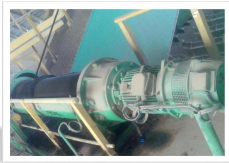
**Figure 3.8 : vue du moteur du treuil des chaînes des bras du grappeur**
