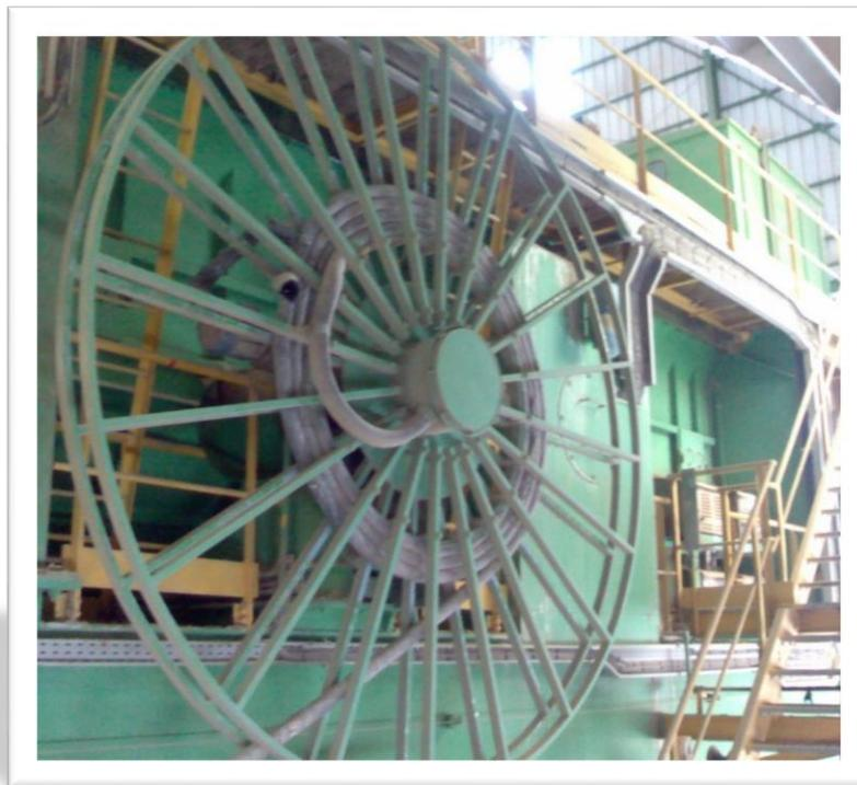
**Figure 3.3 : vue sur l'enrouleur du câble du gratteur**
