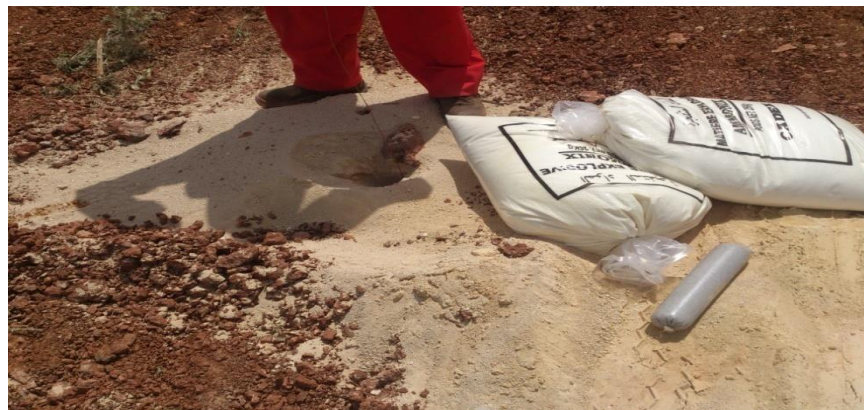
Figure 22: Types d'explosifs, Amorce électrique (Détonateur), tovex, l'Ammonix.
