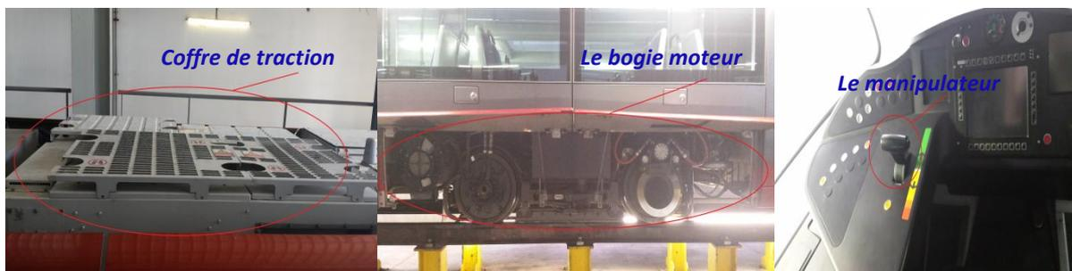
Figure 14: les équipements traction freinage (ETF)
