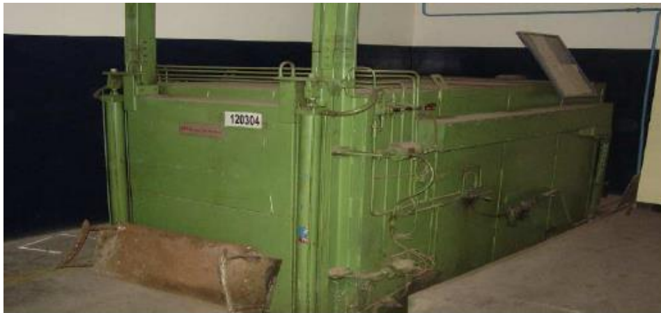
Figure 10 : Four de stabilisation
