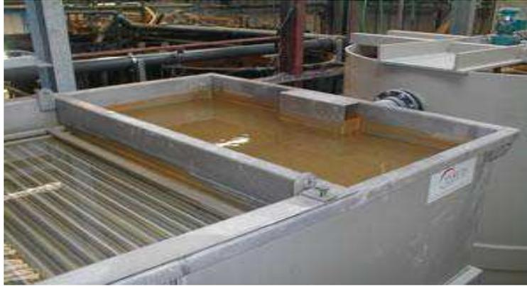
Figure 12 : exemple d'un bac de récupération de l'eau
