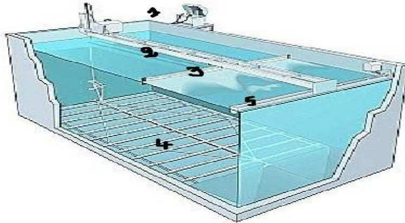
Figure 13 : schéma d'un bac de récupération muni d'un racleur
