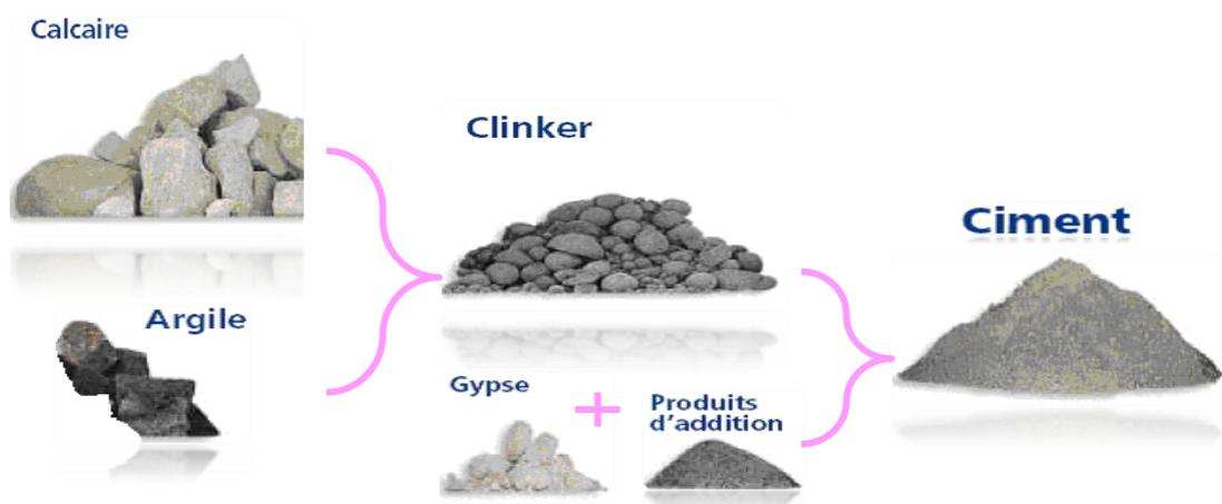
**Figure 3 :** La chaîne de transformation de calcaire et d'argile en ciment.
